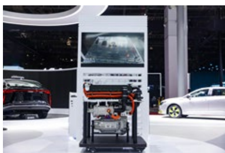
• 东风氢燃料电池系统——东风氢元，体积小、轻量化、氢气利用率高，氢气利用率达到 95%，整体效率高出行业 5% 到 10%
